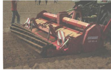
Şək.7. Torpağın başdan-başa becərməsi üçün dəstəlanmış GR kultivator-tirə düzəldən.
