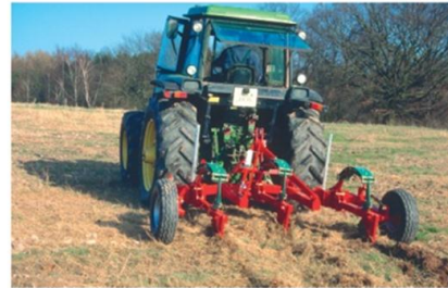
Şək.2. Kultivator – dərin dənyumşaldıcının torpağa təsiri.
