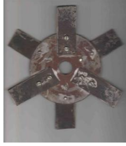
Şək. 3. Eksperimental disk üzərində bıçaqların simmetrik alt-üst yerləşdirilməsi variantları:-3 bıçaq diskin bir tərəfində; -3 bıçaq diskin digər tərəfində.
